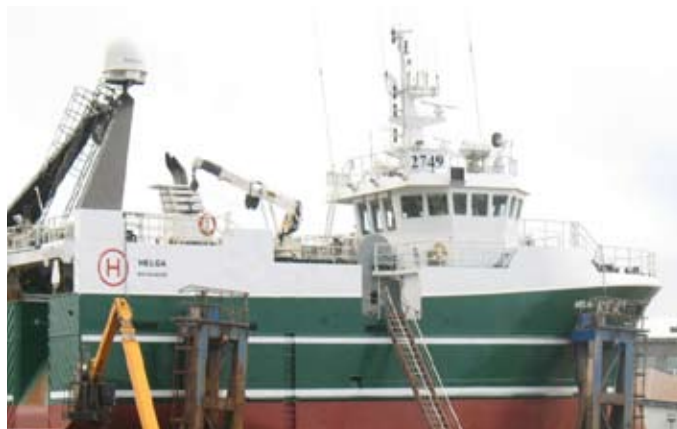
Пример современного 27 м траулера с кормовым слипом с объемом трюма 160 м 3
