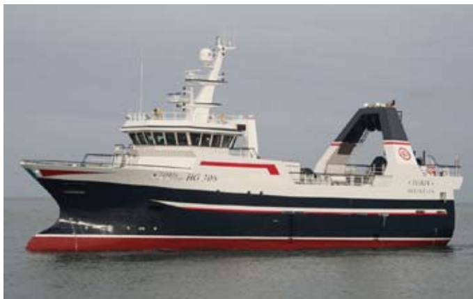
Пример современного траулера-завода длиной между перпендикулярами 34 м, шириной 10 м и общим объемом трюма ок. 380 м 3
